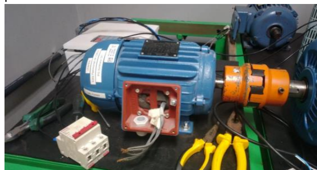
Figura 2. Gerador de 3cv.
