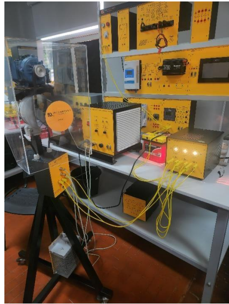
Figura 1: Kit para estudo de mini geração eólica disponibilizado pelo Instituto Federal de Goiás, Câmpus Itumbiara
