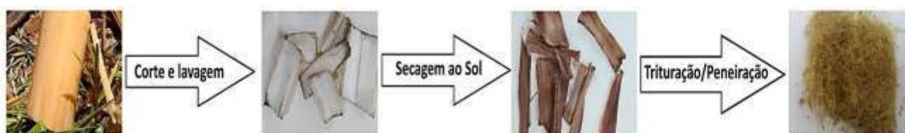
FIGURA 1- FLUXOGRAMA DE PREPARAÇÃO DO PSCB.
