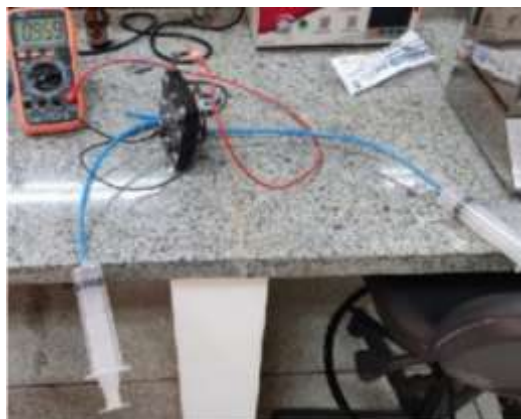
FIGURA 4 – APARATO EXPERIMENTAL DA CÉLULA COMBUSTÍVEL.
