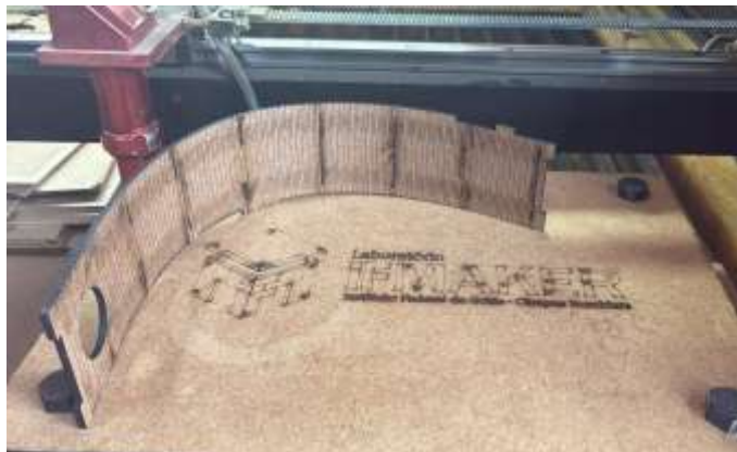
FIGURA 4 - protótipo living hinges .
