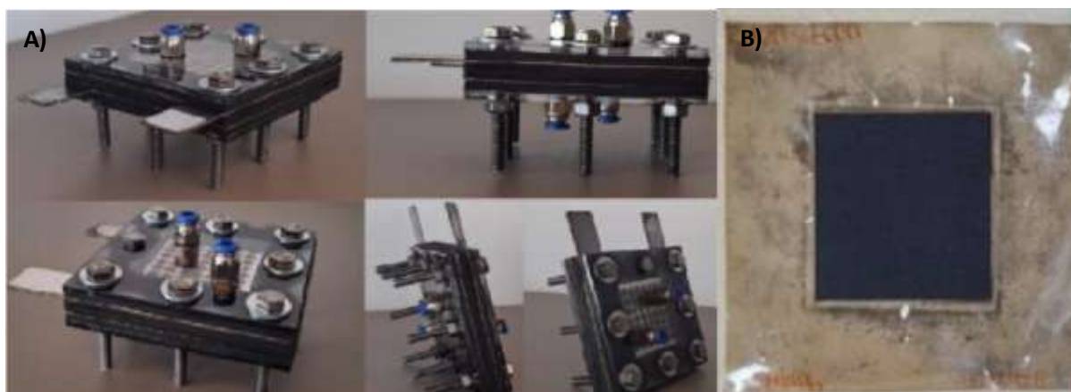
FIGURA 3 – CÉLULA COMBUSTÍVEL CONFECIONADA E MEA UTILIZADA.
