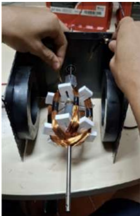
FIGURA 1 – PROTÓTIPO DO MOTOR CC CONSTRUÍDO PELOS ALUNOS
