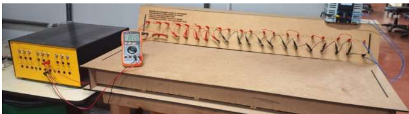
FIGURA 1 - BANCADA DIDÁTICA COMPOSTA POR DEZ MODELOS EM CASCATA.
