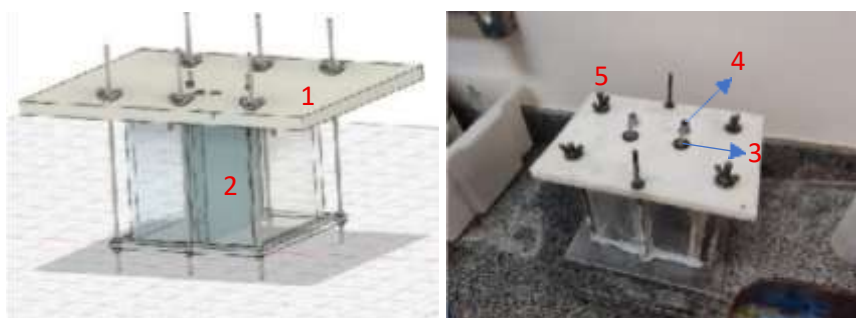
FIGURA 1 – MODELO TRIDIMENSIONAL DO ELETROLISADOR E PROTÓTIPO CONFECCIONADO.
