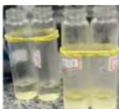
FIGURA 3 - AMOSTRAS NOS TUBOS APÓS O RESFRIAMENTO E PARTIÇÃO À BAIXA TEMPERATURA.
