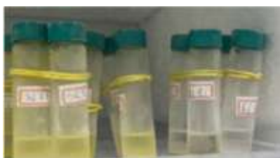
FIGURA 2 - ADIÇÃO DAS AMOSTRAS NO FREEZER PARA PARTIÇÃO À BAIXA TEMPERATURA.
