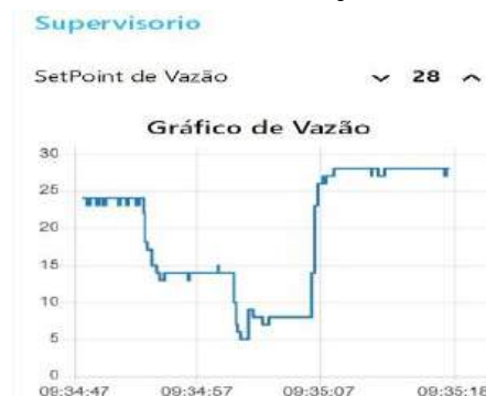
FIGURA 10 - SUPERVISÓRIO ELABORADO NO NODE-RED SE COMUNICANDO COM O MICROCONTROLADOR VIA MQTT.
