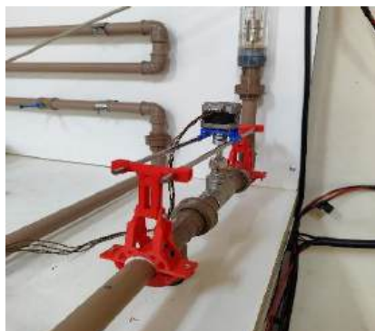
FIGURA 9 – VÁLVULA DE CONTROLE DO TIPO GLOBO MONTADA NA BANCADA EXPERIMENTAL COM O SUPORTE.
