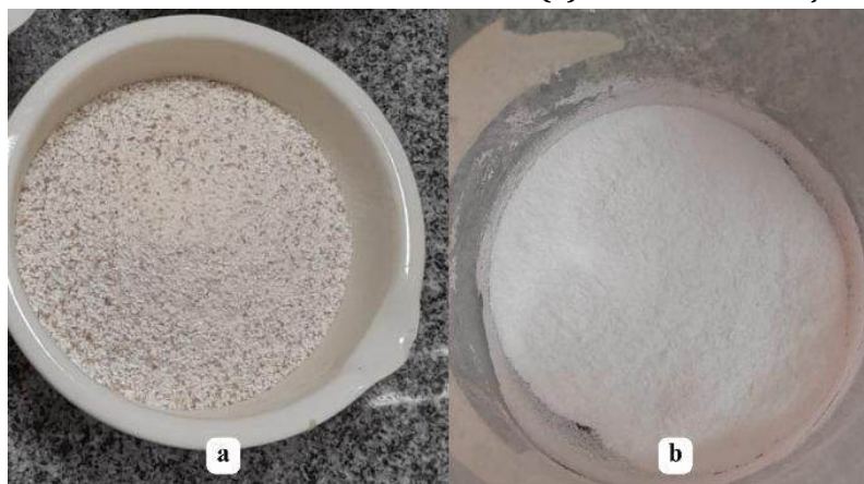
FIGURA 3 –CASCAS DE OVOS IN NATURA (a) APÓS A CALCINAÇÃO A 850 °C POR 4h (b).
