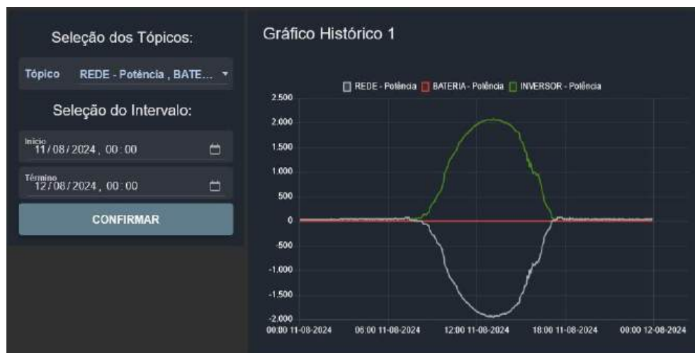
FIGURA 5 - CONSULTA HISTÓRICA DO SISTEMA DE SUPERVISÃO E CONTROLE DE INVERSORES HÍBRIDO.
