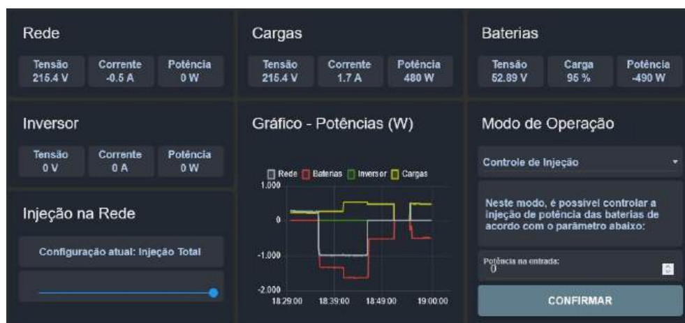
FIGURA 4 - TELA INICIAL DO SISTEMA DE SUPERVISÃO E CONTROLE DE INVERSORES HÍBRIDOS.
