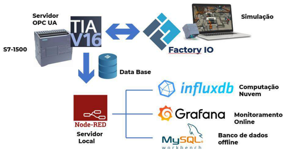
FIGURA 1 - FLUXOGRAMA DE SOFTWARES E HARDWARES.
