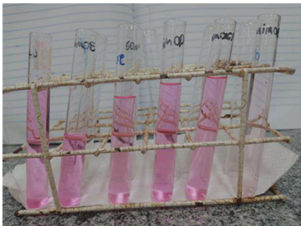
FIGURA 3- DEGRADAÇÃO RODAMINA B PERCEBIDA PELA DIMINUIÇÃO VISÍVEL DA COR ROSA DURANTE 150MIN DE ENSAIO FOTOCATALÍTICO USANDO O TiO_2 EM MEIO ÁCIDO E OXIDANTE.
