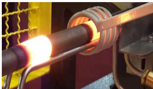
Figura 2 - Indutor eletromagnético aquecendo a ponta da peça até temperatura de austenitização (CHIAVERINI, 1986).
