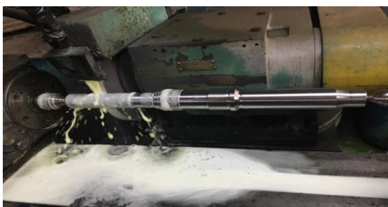
Figura 1 - Retifica VIGORELLI - KU12/36, rebolo de 10", grana 120 e rotação de 1600rpm.
