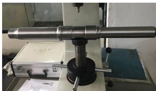
Figura 3 - Durômetro ASIMETO, onde utilizou-se penetrador de diamante com geratriz de 120° (CALLISTER, 2012).
