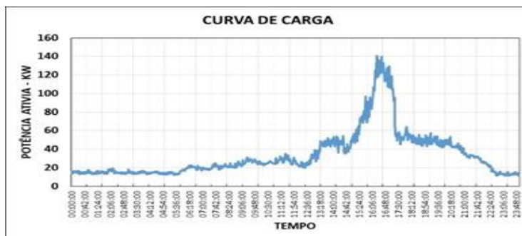
Figura 3 - Curva de carga diária obtida por medições no quadro geral de baixa tensão no IFG – Campus Itumbiara.
