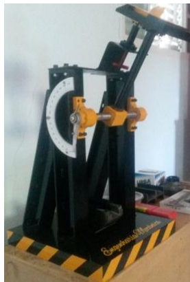
Figura 2 - Máquina de Ensaio de Impacto Charpy utilizada.
