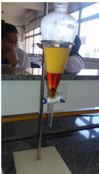
Figura 1 - Funil de separação com biodiesel e glicerina.
