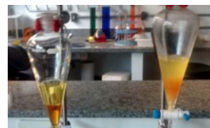
Figura 2: Decantação do biodiesel em catálise (a) por KOH (à esquerda) e por (b) NaOH (à direita)
